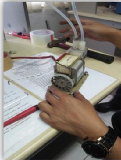
SO 2 Analyzer Trace Level Enhanced Model 43i-tle dan pompa yang rusak
