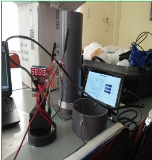
Peralatan Pengukur PM 2,5 yang akan dipasang beserta Display
