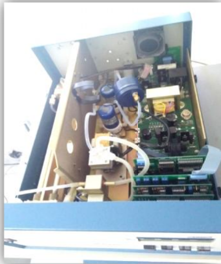
SO 2 Analyzer Trace Level Enhanced Model 43i-tle dan pompa yang rusak
